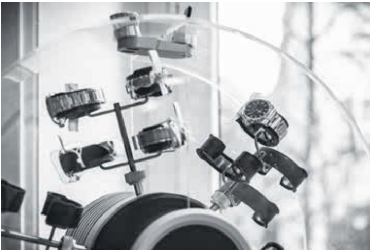
Ob der automatische Aufzug perfekt funktioniert, zeigt der Zyklotest.
