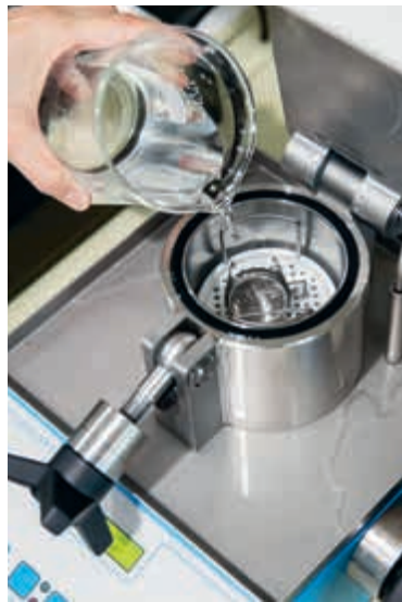
Im Fathometer kann ein reeller Druck wie in 1220 Meter Tiefe hergestellt werden: Hier wird die Wasserdichtigkeit geprüft.
