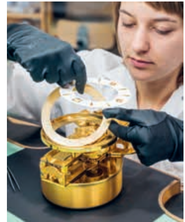
Ausbau: Zeiger, Zifferblatt, Membrane und Federspirale werden abgeschraubt, überprüft und gereinigt.
