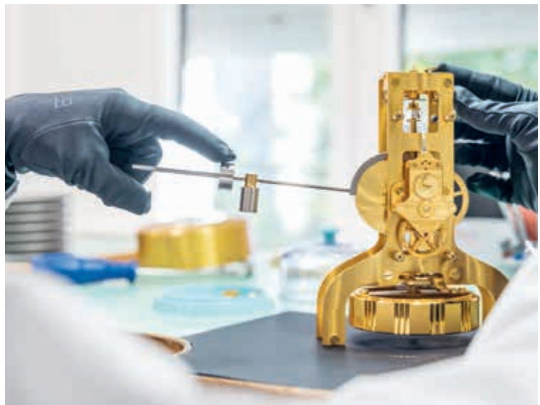
Energietest: Mit einem Prüfgerät wird dem Werk der «Atmos» der Puls gefühlt - wie viel Kraft besitzt es noch?
