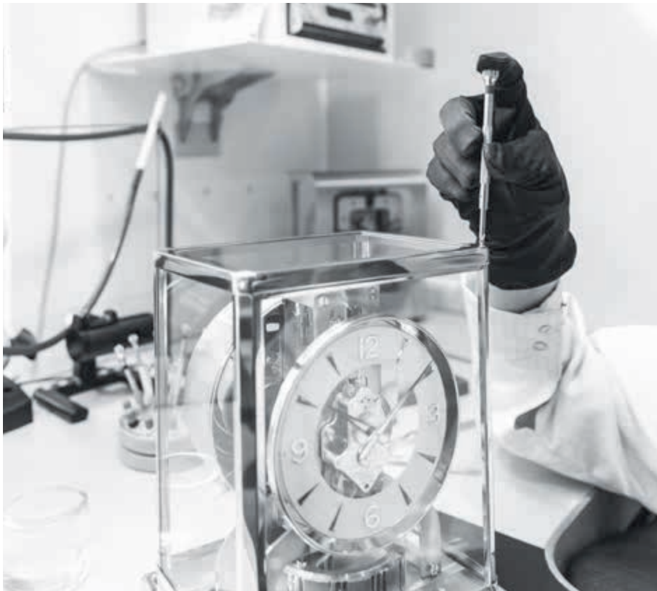
Ausbau: Zeiger, Zifferblatt, Membrane und Federspirale werden abgeschraubt, überprüft und gereinigt.
