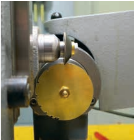
Die Scheibe, die das Schlagwerk reguliert, im revidierten Werk.
