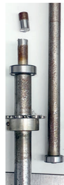
Rostige Achsen, verklemmte Zahnräder: Rund einen Monat arbeiteten die Uhrmacher an Ersatzteilen.
