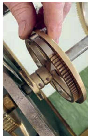
Rostige Achsen, verklemmte Zahnräder: Rund einen Monat arbeiteten die Uhrmacher an Ersatzteilen.
