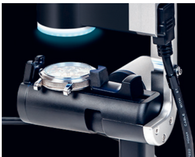
Prüft den Gang von Uhren optisch wie akustisch: WisioScope.
